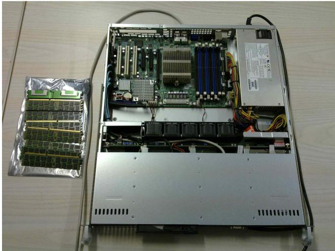
Erstens konnte ich bei geschlossenem Gehäuse (1 HE=Höheneinheit) keinen Raid-Kontroller mit BBU-Einheit (Batterie) einbauen. Dies wäre notwendig gewesen, denn der eingebaute Adaptec-Kontroller entpuppte sich als Einstiegs-Modell, der nur mit entsprechend bestücktem Kernel (d.h. mit Software) als Raid-Kontroller überhaupt hätte betrieben werden können.
