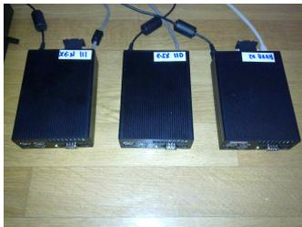
Der Stromverbrauch im Idle liegt hier bei 25 Watt bzw. ca. 40 Watt unter Last (pro Maschine).
